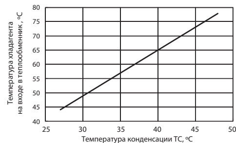
Рис. 2. Температура хладагента на входе в теплообменник
